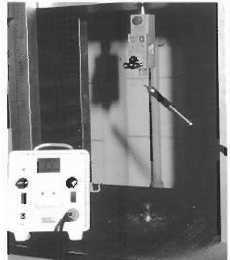
Fig. 13 - Simulatore fissato al Dinamometro Elettronico in grado di registrare la forza sviluppata attraverso il plugger durante l'otturazione con il System B.
